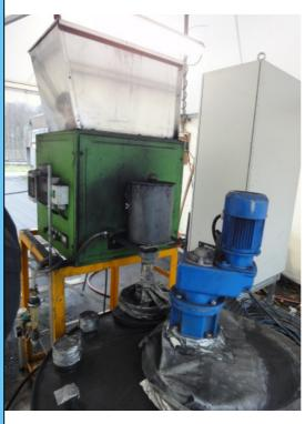
Bild 2: Pulverkohledosieranlage vor dem Versuchstropfkörper
